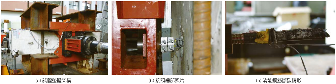
圖 5 接頭試驗照片
