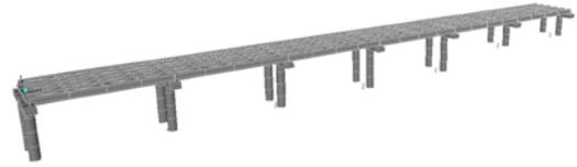
圖 12 橋梁結構分析模型圖
